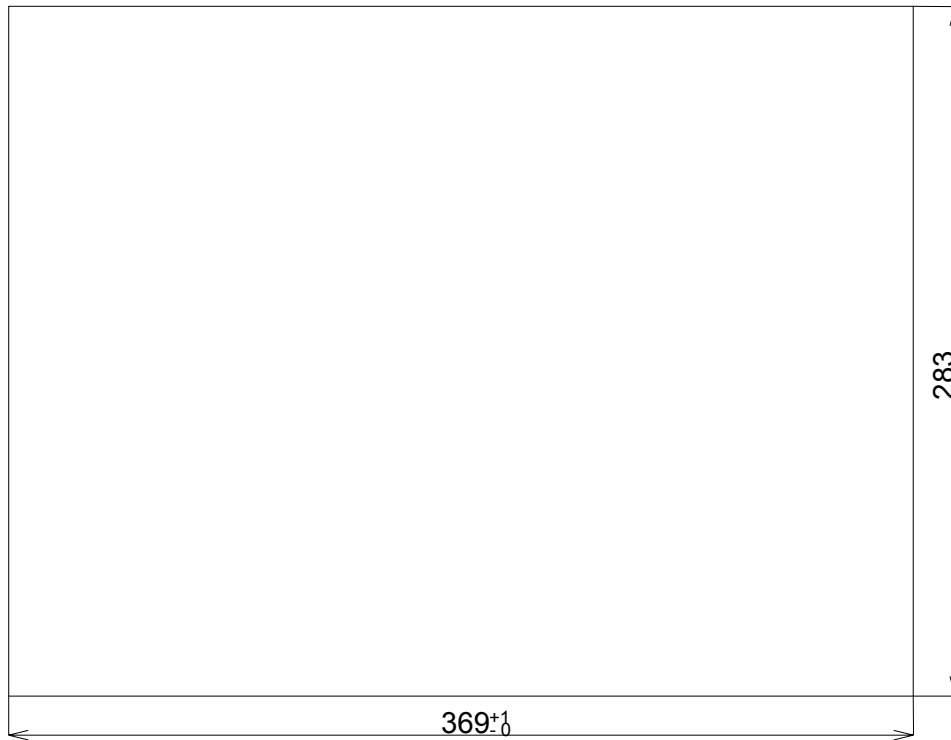
Obr. 1 Rozměry výřezu pro upevnění operátorského panelu
